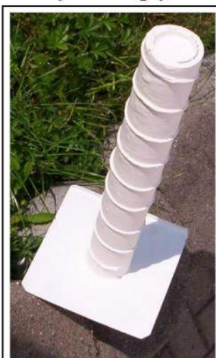
Bild 5: Helix-Antenne für zirkular polarisierte electromagnet. Wellen
